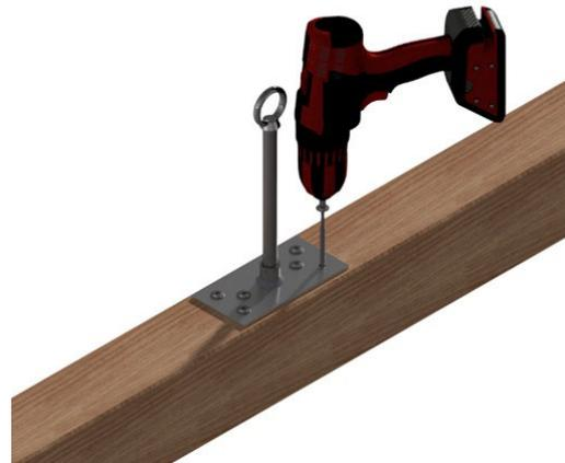
Die mitgelieferten Tellerkopfschrauben mit einem Akkuschauber durch die vorgefertigten Löcher eindrehen. Bitte verwenden Sie einen Torxkopf TX 40.
