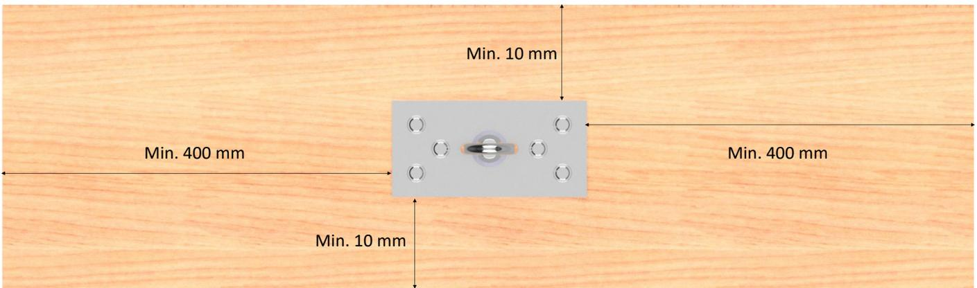
Die Anschlagereinrichtung sollte grundsätzlich gemäß DGUV Regel 201-056 in einem Abstand von mindestens 2,5 m zur Absturzkante montiert werden. Der Abstand zwischen den Anschlagereinrichtungen darf bei Seilsystemen 10 m nicht überschreiten. Bei Einzelanschlagpunkten sollte der Abstand zwischen den Anschlagereinrichtungen 7,5 m nicht übersteigen.
