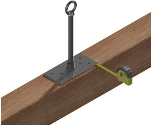
Mittig auf dem Balken platzieren. Der Mindestabstand zum Balkenende beträgt 400 mm und zur Balkenseite 10 mm.
